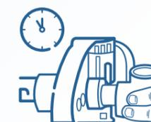
**4.** Mantén las piezas en los dados del Termofusor el tiempo indicado para el diámetro de la Tubería.
